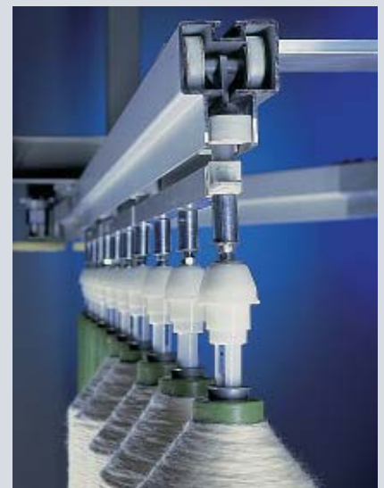
Textra – Schienenprofil mit Spulenzug Textra – track profile with bobbin train
