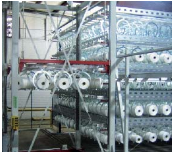
Passiv-Extra-Spulenspeicher mit Verteilwagen Passiv-Extra-package buffer with shuttle
