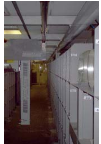
Automatischer Gatterspeicher Automatic creel buffersystem
