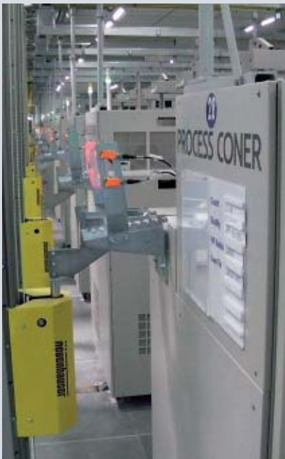
Kreuzspulenlifter und TEXTRA-Hänge- förderer-System an Spulmaschine Package Lifter and TEXTRA-Overhead Conveyor System for winding machine
