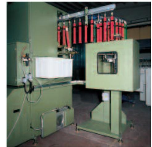
7. espulsione di una spola non pulita e sostitutore automatico spole (opzione) per reintegrare con spole pulite le posizioni vuote del treno
